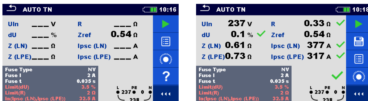
Figur 8.11: Exempel på resultat av AUTO TN mätning
