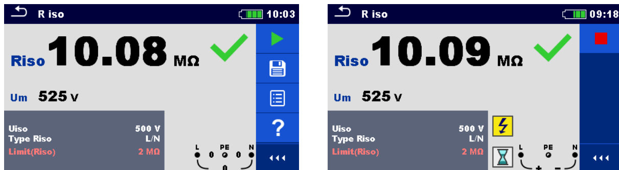
Figur 6.1: Singeltestskärm uppbyggnad, exempel på isolationsresistansmätning
