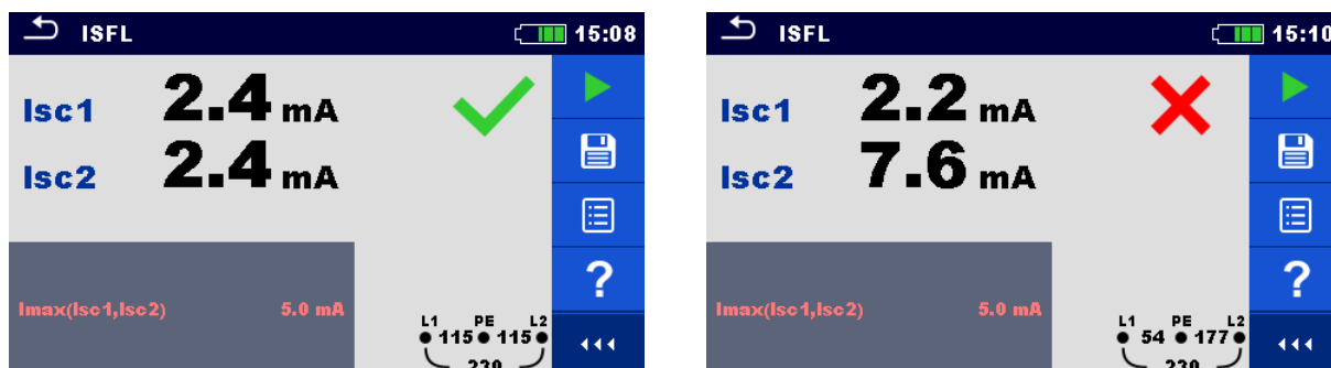
Figur 7.70: Exempel på resultat vid First fault leakage current mätning
