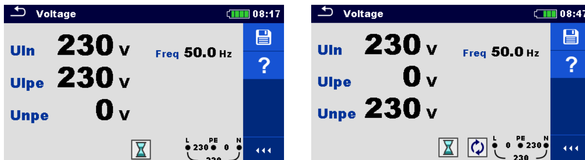
Figur 7.4: Exempel på Spänningsmätning i ett enfasssystem
