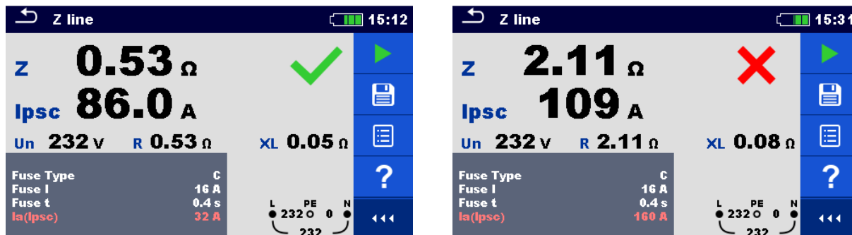
Figur 7.40: Exempel på resultat vid Line-impedansmätning
