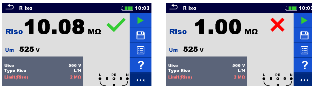
Figur 7.9: Exempel på resultat isolationsresistansmätning
